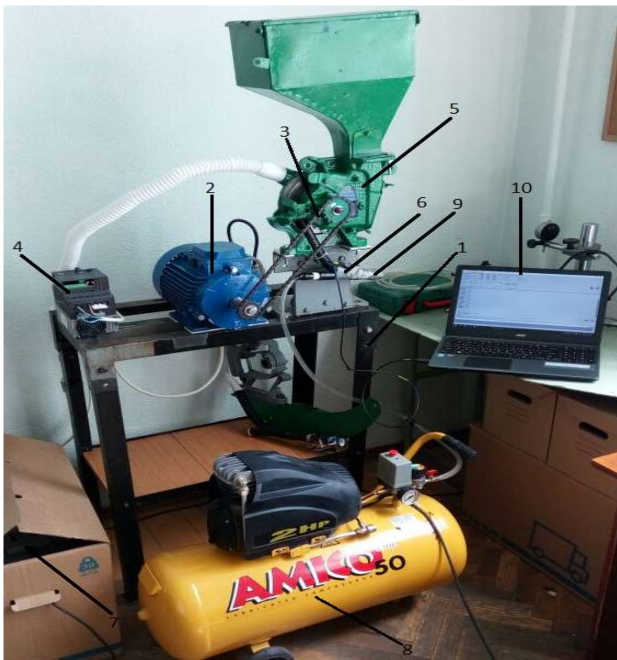
Рис. 6. Лабораторная установка для исследований пневматических высевальных аппаратов: 1 – рама, 2 – электродвигатель постоянного тока, 3 – приводная цепь, 4 – частотный преобразователь, 5 – экспериментальный высевальной аппарат, 6 – семяпровод, 7 – вакуумная установка с регулятором разрежения, 8 – компрессор, 9 – датчики измерения скорости семян на выходе из семяпровода, 10 – персональный компьютер
